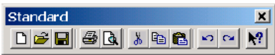
Abbildung 3. Sichtbare Zwischenräume - in dieser Version der Toolbar ist die Eigenschaft Style der Zwischenräume auf 1 - vertikale Linie gesetzt, so dass sie zur Laufzeit sichtbar werden.
